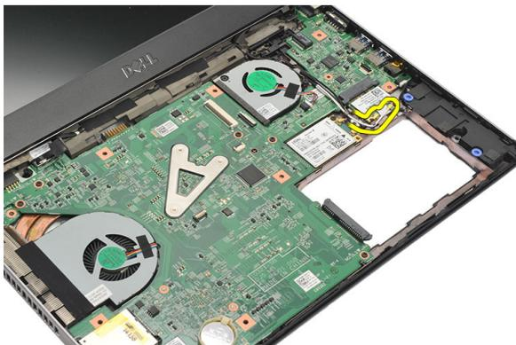
8. Retire o parafuso que fixa a placa WLAN à placa de sistema.
