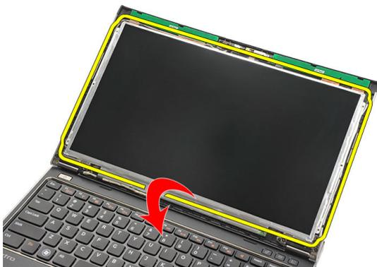
12. Destaque a fita adesiva que fixa a ligação de sinalização diferencial de baixa tensão (LVDS) ao painel do ecrã.
