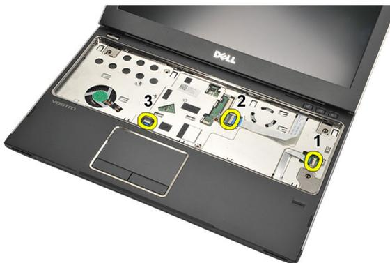
9. Utilizando um instrumento aguçado em plástico, levante com cuidado os lados do apoio para as mãos e retire-o do computador.
