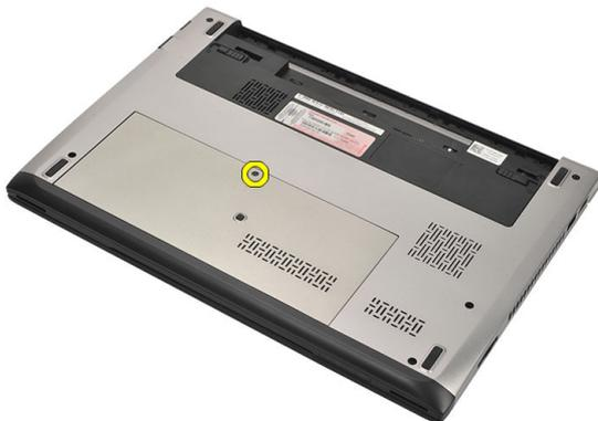
4. Deslize a tampa da base em direcção à parte frontal do computador. Levante-a e retire-a do computador.
