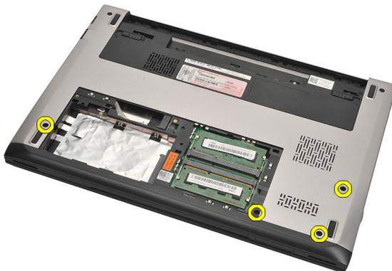
7. Retire os parafusos existentes no apoio para as mãos.
