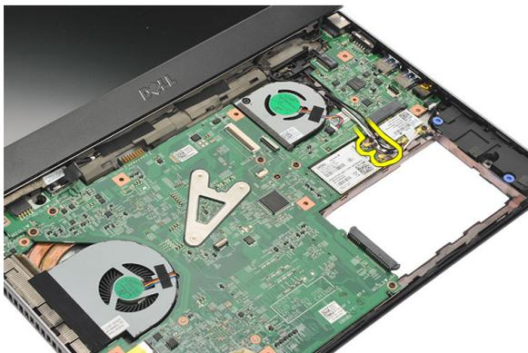
8. Retire o parafuso que fixa a placa WWAN à placa de sistema.
