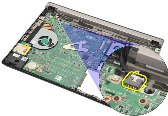
14. Retire os parafusos que fixam a placa de sistema ao chassis.
