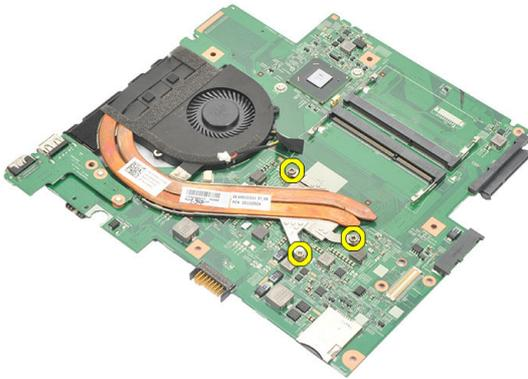
**16.** Levante o dissipador de calor e retire-o da placa de sistema.
