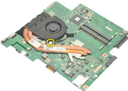
15. Desaperte os parafusos que fixam o dissipador de calor à placa de sistema.
