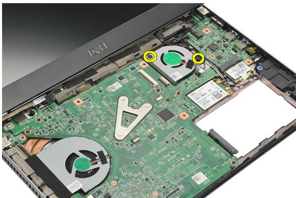
9. Levante o ventilador e retire-o do computador.
