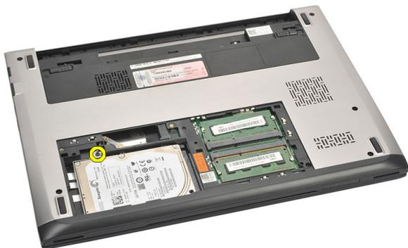
5. Faça deslizar o módulo da unidade de disco rígido para a esquerda.
