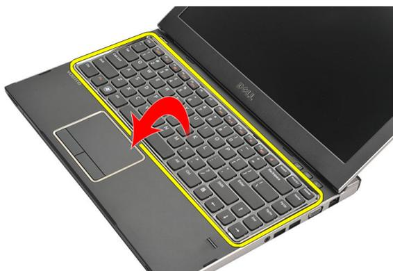
5. Levante o grampo para libertar o cabo do teclado e desligue-o da placa de sistema.
