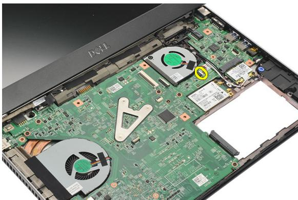
8. Retire os parafusos que fixam o ventilador ao computador.
